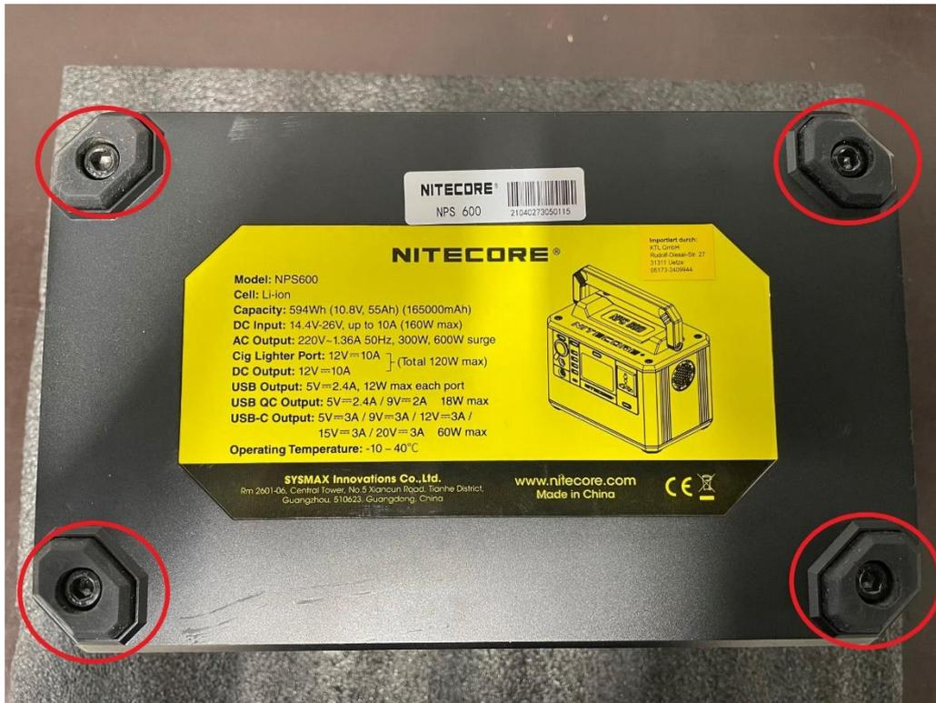
Nun die beiden Kabelpaare trennen. Nach ca. 5 Minuten wieder zusammenstecken und die Bodenplatte wieder aufschrauben.
